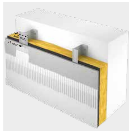
Fig. 3: giunti delle lastre accostati in modo compatto (larghezza giunto \leq 1 mm) per ricevere un rivestimento a intonaco.
